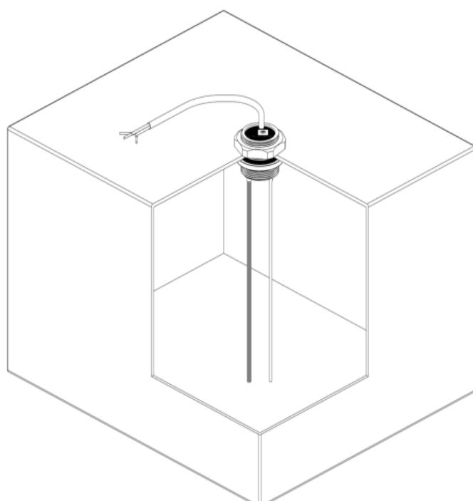
Die **Tankelektrode** wird zur Füllstands-Fermessung direkt am Tank montiert und ist geeignet für:
