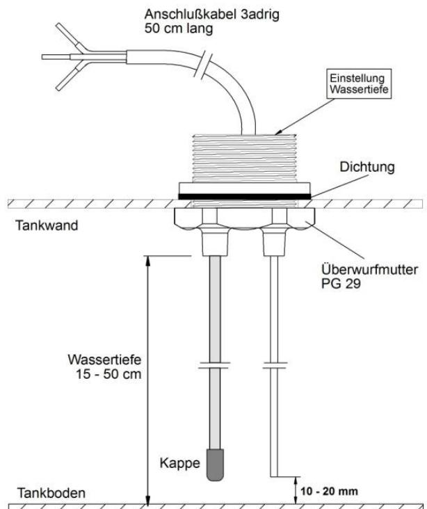
Danach werden beide Stabsonden auf gleiche Länge gekürzt (Metallsäge, kräftiger Seitenschneider, Bolzenschneider).
