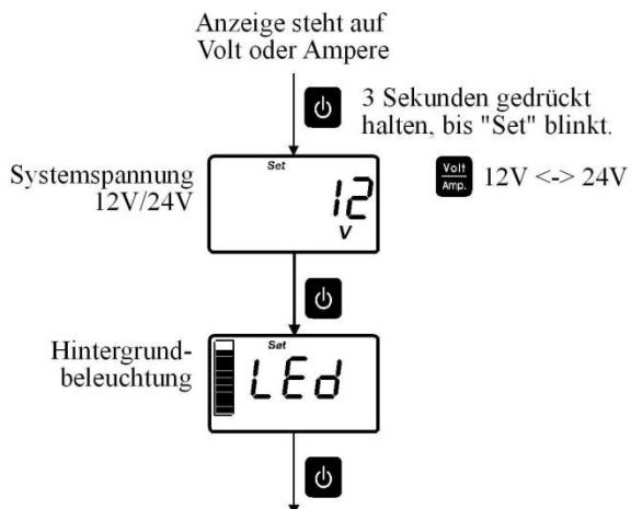
Das Menü zur Einstellung wird aufgerufen indem die Taste 2 für über 3 Sekunden gedrückt gehalten wird bis „Set“ blinkt.
