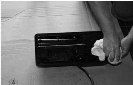
Ontvetten van de pomp unit
