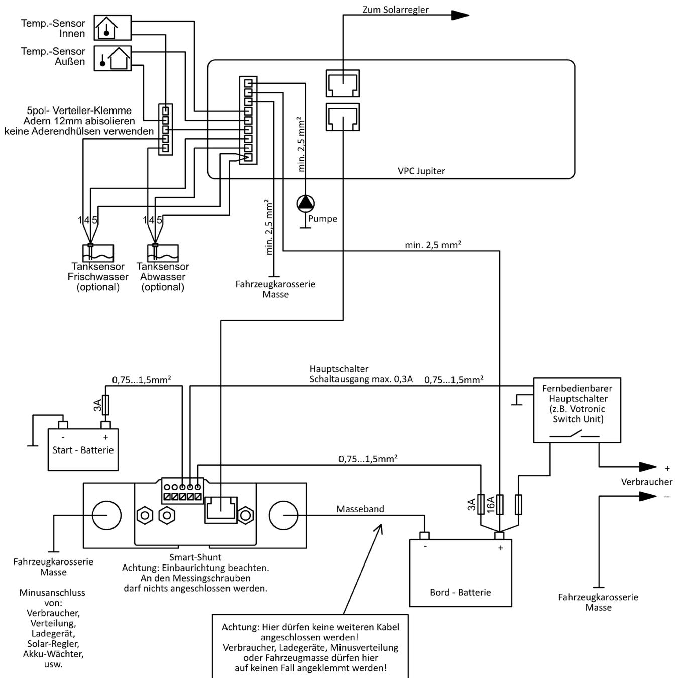
Alle Klemm-Anschlüsse sind so ausgelegt, dass keine Aderendhülsen verwendet werden dürfen. Die 9-polige Klemme am Anzeigepanel ist eine Steck-Klemme und kann zur Montage abgezogen werden. Die Kabelquerschnitte sind der Zeichnung zu entnehmen. Sicherungen dienen dem Kabelschutz und müssen daher möglichst nahe an der Batterie sitzen.
